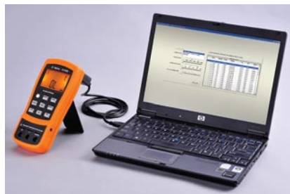
Рис. 1. Автоматизированная регистрация результатов измерений при подключении U1701A/U1701B к ПК
