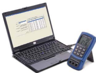
Рисунок 1 - Автоматизация записи непрерывных отсчётов при подключении U1731A/32A к ПК
