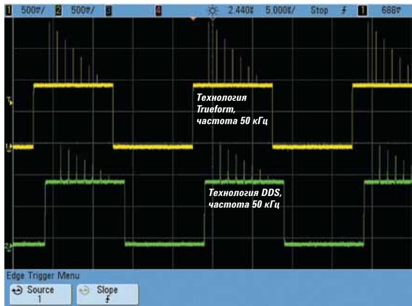
Рис. 5. Сравнение сигналов произвольной формы на частоте 50 кГц
