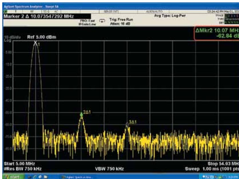
Рис. 1. Гармоники сигнала, созданного по технологии *Trueform*
