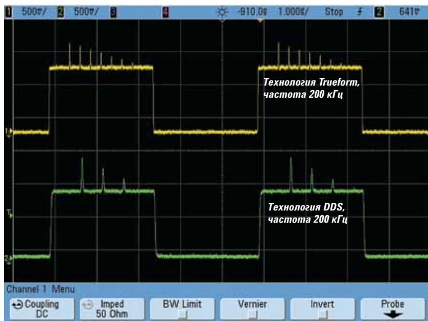
Рис. 6. Сравнение сигналов произвольной формы на частоте 200 кГц
