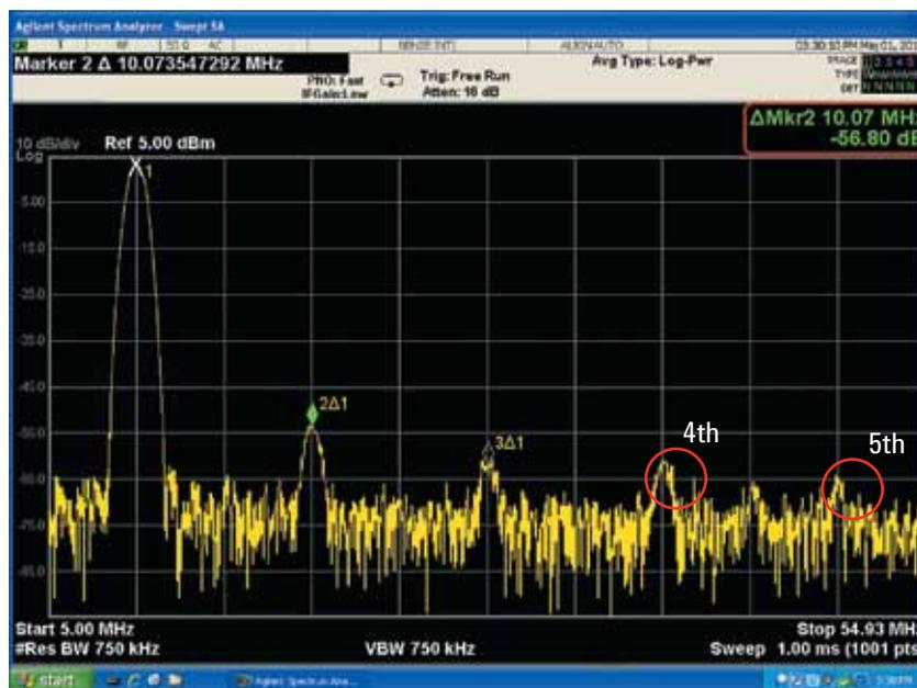
Рис. 2. Гармоники сигнала, созданного по технологии DDS
