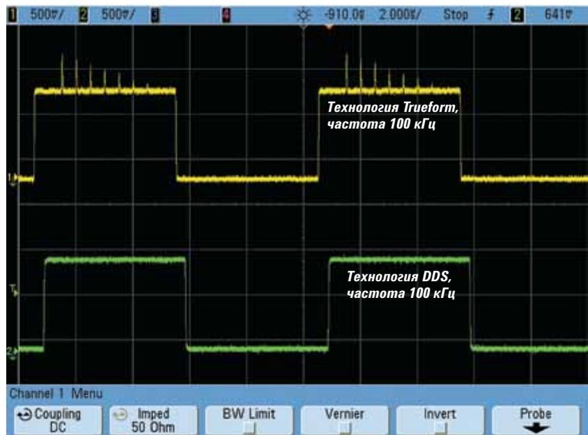
Рис. 6. Сравнение сигналов произвольной формы на частоте 100 кГц
