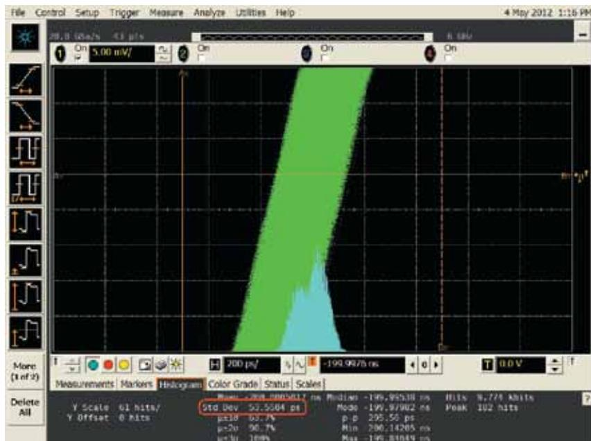
Рис. 4. Измерение джиттера сигнала, созданного по DDS
