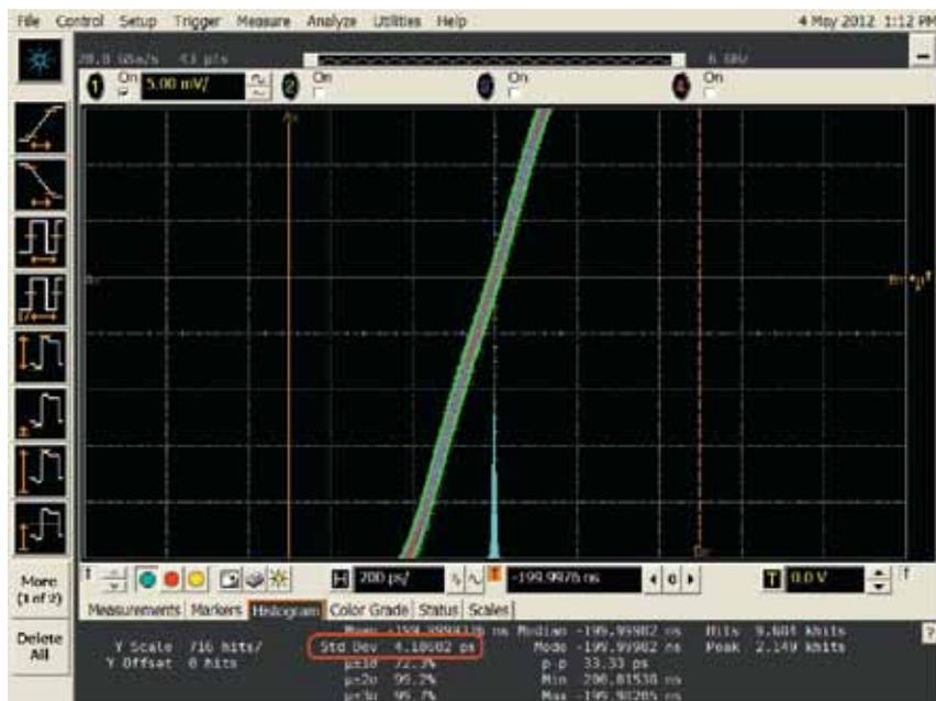
Рис. 3. Измерение джиттера сигнала, созданного по Trueform
