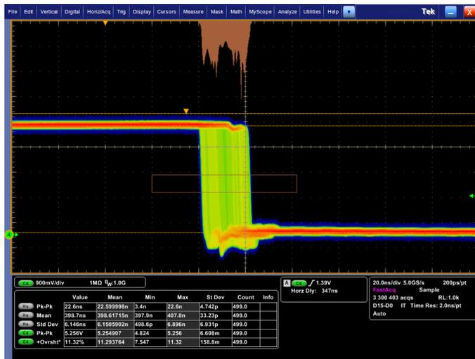
Анализ. Гистограмма спада сигнала, отображающая распределение положения фронта (джиттер) во времени. Приведены численные результаты измерений, выполненных на гистограмме сигнала. Обширный набор встроенных средств анализа позволяет ускорить проверку тестируемого устройства
