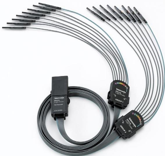
В комплект поставки осциллографов MSO5000 входит 16-ти каналный цифровой пробник R6616 с двумя подами по 8 каналов для облегчения подключения к тестируемому устройству.
