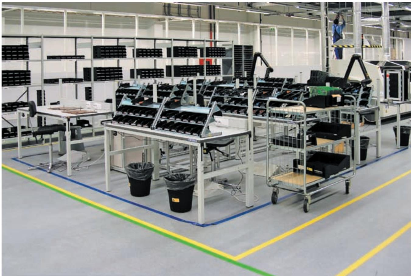
VKG ESD CBX – антистатическое эпоксидное напольное покрытие, специально разработано для помещений, защищенных от электростатических разрядов, в которых необходимо одновременное соответствие следующим требованиям:
