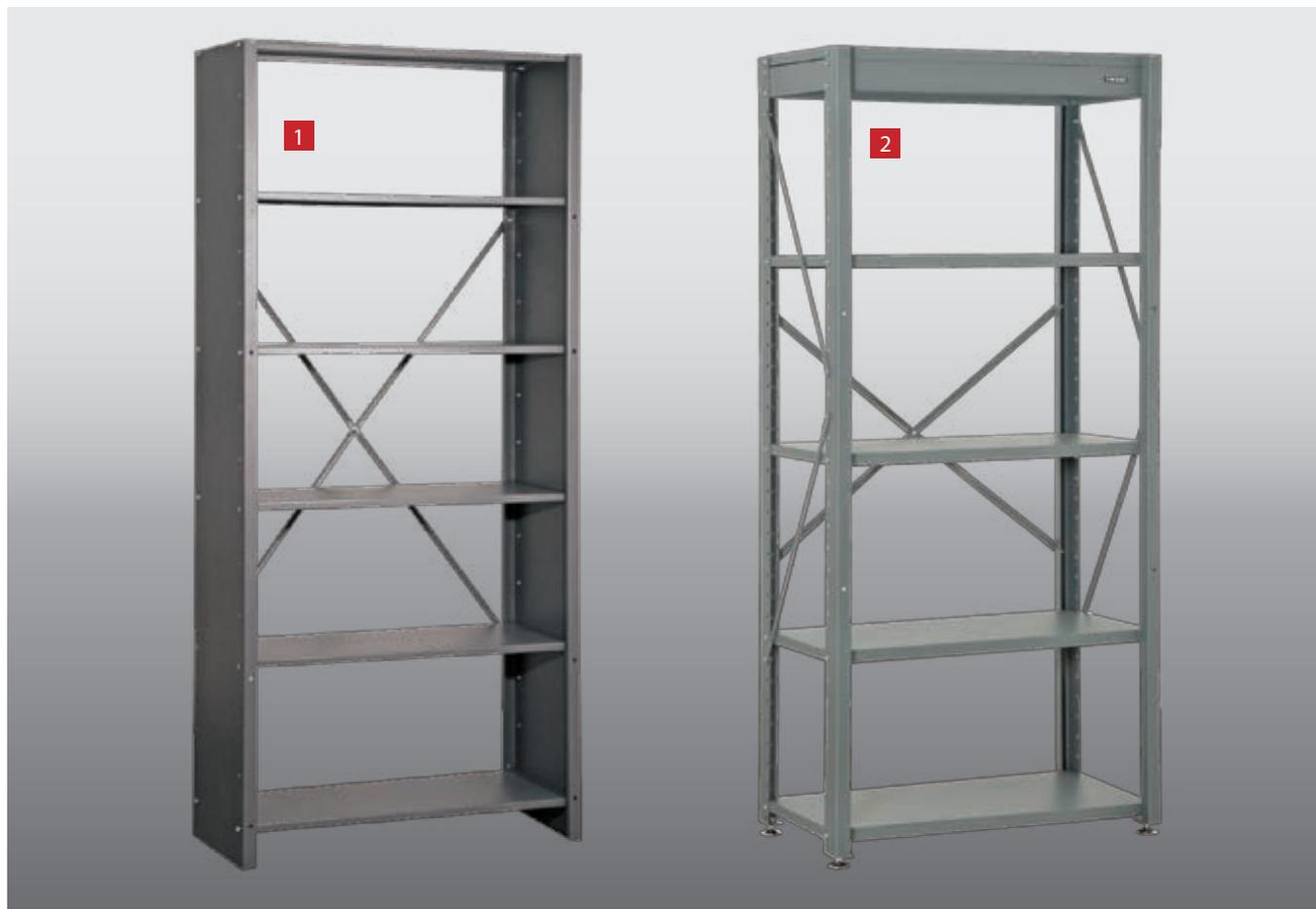
Стеллажи универсальные предназначены для хранения документации и комплектующих. Стеллажи (кроме СТУ-01) имеют регулируемые опоры стоек, 5 полок в стандартной комплектации. возможность регулировки полок по высоте с шагом 50 мм, распределенная нагрузка на полку до 80 кг. Стеллаж СТУ-01 в стандартной комплектации имеет 6 полок, распределенная нагрузка на полку до 30 кг.
